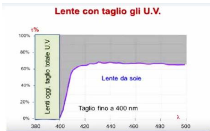
Figura 22. Curva di trasparenza alla radiazione luminosa di una lente colorata da sole con eliminazione della radiazione più dannosa e riduzione della intensità luminosa che raggiunge l'occhio.
