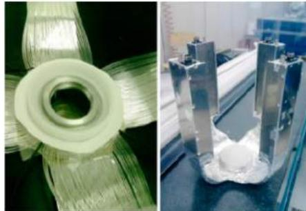
*Figura 2.2: Start Counter. A sinistra si può osservare un foglio dello scintillatore e fibre ottiche raggruppate in quattro bracci. A destra osserviamo l’intero rivelatore.*
