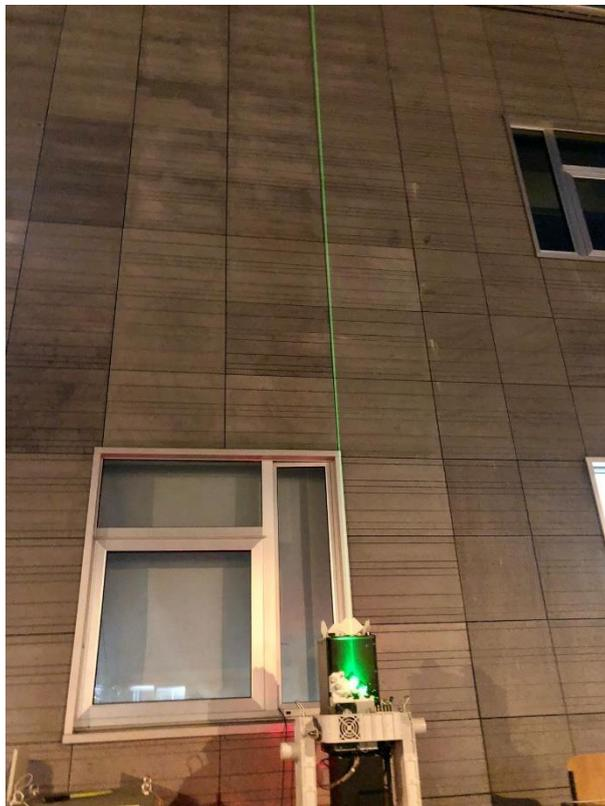
Figura 8: L'apparato lidar in funzione durante una sessione di misure Raman serali. Le lunghezze d'onda in uscita dal sistema sono le 355 nm e 532 nm. Solo la seconda è visibile ed è di colore verde.
