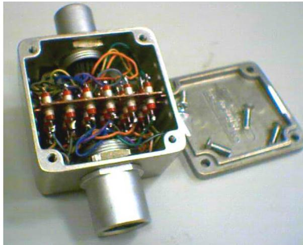
Figura 3.18: Filtri EMI utilizzati nel Triton.
