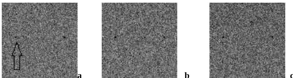
Figura 2.18. Microcalcificazioni di diametro 180 \mu\text{m} delle proiezioni per fantoccio di spessore di 20 mm per le aperture del fascio sul rivelatore di a) 200 mm, b) 80 mm e c) 10 mm. Si osserva nitidamente la riduzione del diametro della microcalcificazione rispetto alle precedenti immagini.
