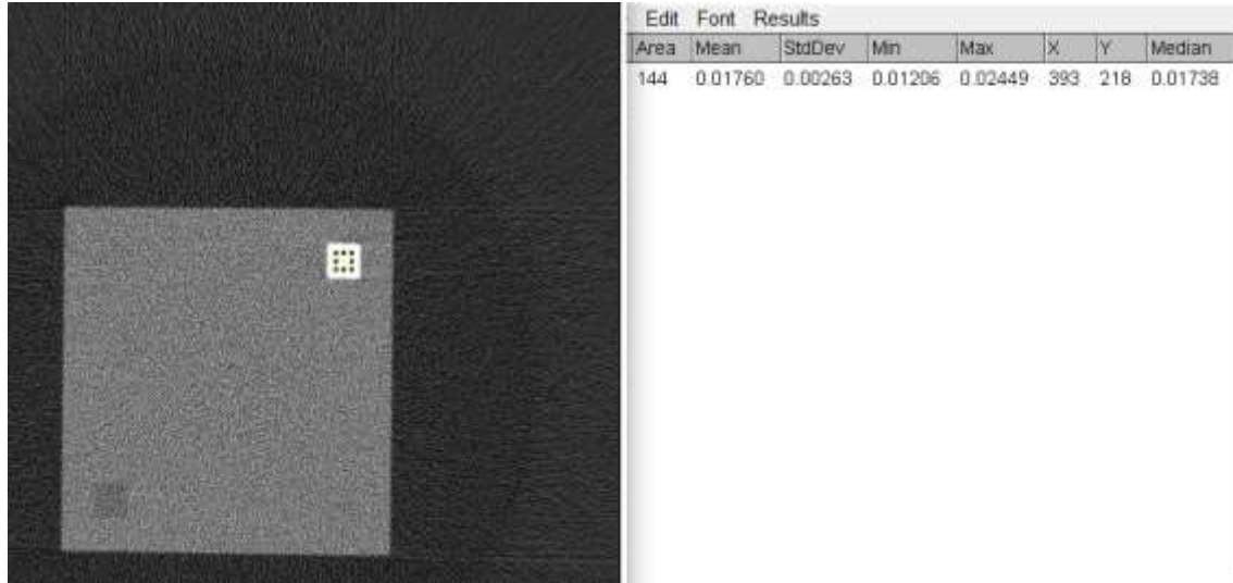
Figura 4.4. Valutazione del coefficiente di attenuazione lineare del PVC nella slice centrale per il fantoccio ricostruito con configurazione CBCT, effettuata servendosi del software ImageJ. Non sono visibili tutti e quattro gli inserti per ridotto CNR rispetto al fondo di PMMA.
