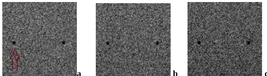
Figura 2.16. Microcalcificazioni di diametro 250 \mu\text{m} delle proiezioni per fantoccio di spessore di 20 mm per le aperture del fascio sul rivelatore di a) 200 mm, b) 80 mm e c) 10 mm.
