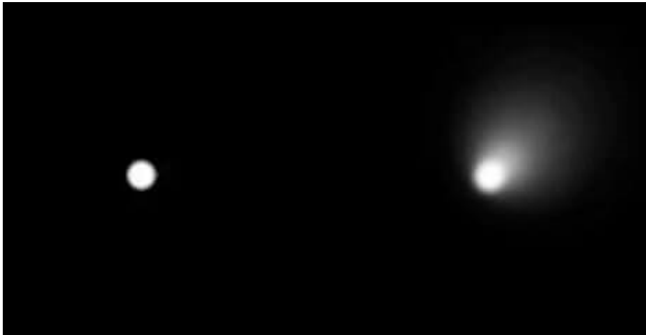
Figura 12 - Punto luce visto con un'aberrazione di coma
