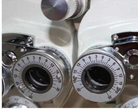
**Figura 13:** Prismi di Risley al forottero
