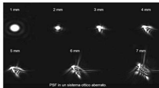
(Figura 12 Il PSF in un sistema ottico aberrato, visualizzato con il DNEye Scanner. MN- products management lenses and instruments)
