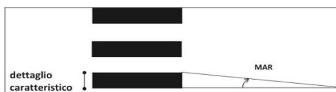
Figura 8 - Minimo angolo di risoluzione (MAR)
