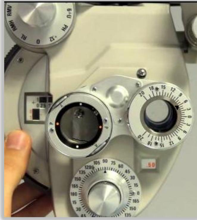
fig.9 Prisma di Risley 6<sup>Δ</sup>BA
