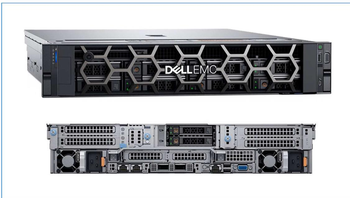
In merito all'efficienza energetica, si specifica che i sistemi R7525 sono dotati di una nuova funzionalità chiamata "Multi Vector Cooling" che rileva automaticamente la tipologia e l'assorbimento delle schede PCIe installate (p.es. le GPU) e fornisce automaticamente il flusso d'aria corretto allo slot per raffreddare quella scheda.
